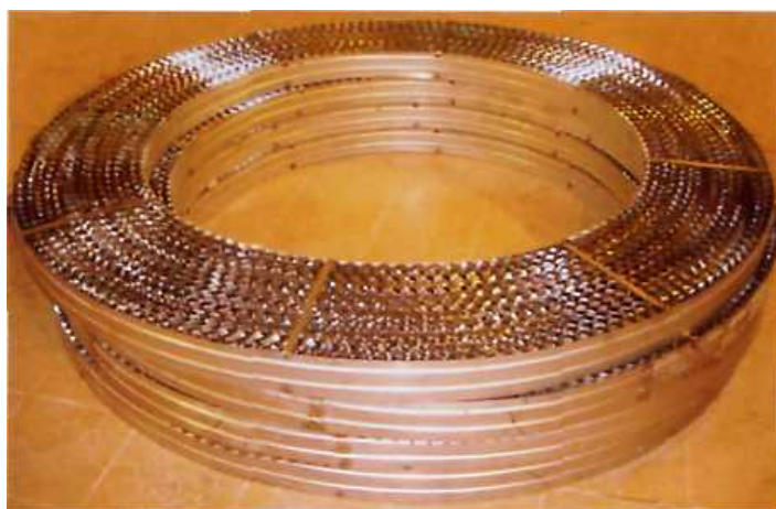
Рис. 13.8. Сегментная регулярная насадка
