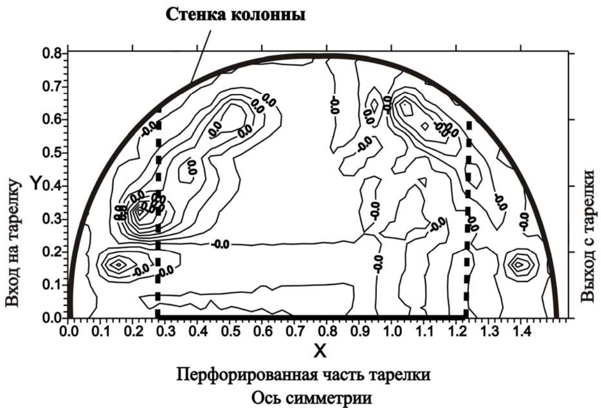
Рис. 18.8. Профиль безразмерной составляющей скорости v на тарелке в сечении z = H/4
