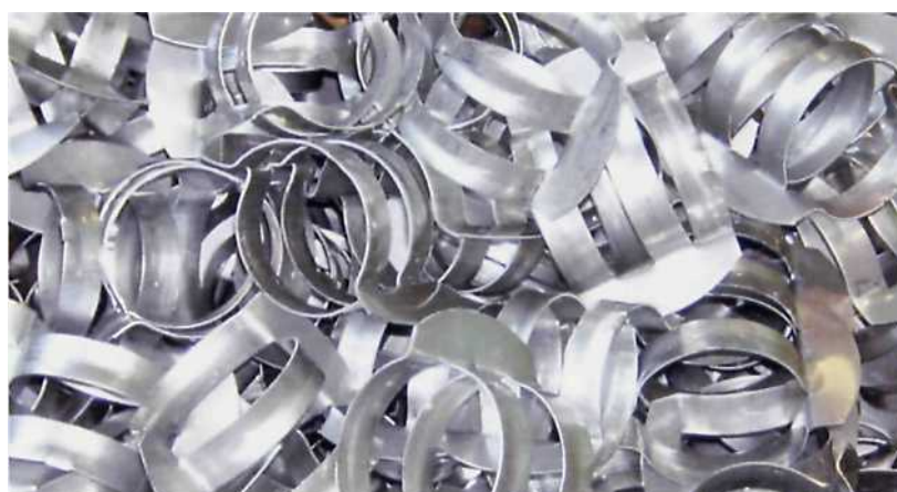
Рис. 13.11. Вид насадочного слоя
