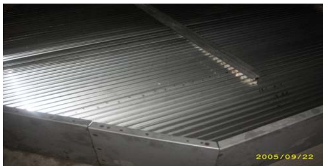
Рис. 13.6. Каплеуловитель шевронный «Инжехим»
