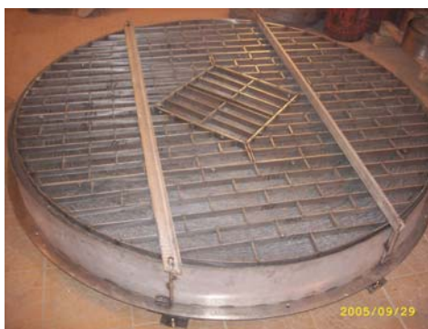
Рис. 13.5. Каплеуловитель сетчатый «Инжехим»
