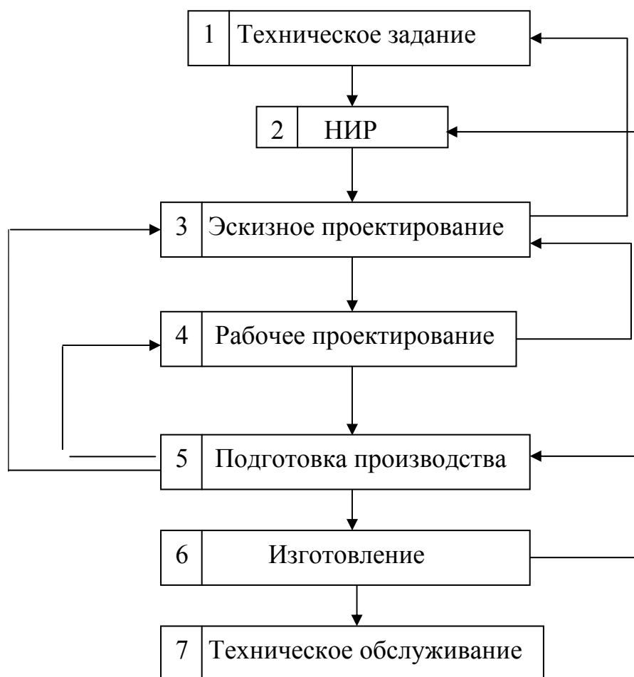
Рис. 1.1. Разработка и изготовление промышленного объекта
